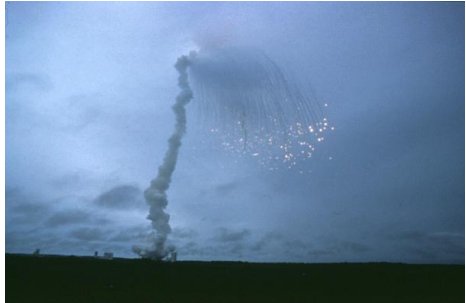
Abbildung: Ariane 5 V88-Fehlschlag (float64-zu-int16-Typumwandlungsüberlauf), 4. Juni 1996, 300 Millionen Euro Schaden (Quelle: ESA 229241)
